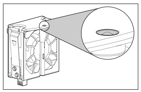
Figure 4-10. Hot-plug fan LED
